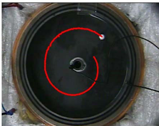
그림 1. 사이클로트론 원리를 재현한 실험 장치와 실험 사진. 붉은 색선은 흰색 포개개 시간이 지남에 따라서 중앙에서 바깥쪽으로 이동하는 것을 연속 촬영한 것임.
